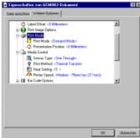
**Bild 9 i**      **Einstellung der Druckparameter - Optionen für Dokument unter Windows NT 4.0**
