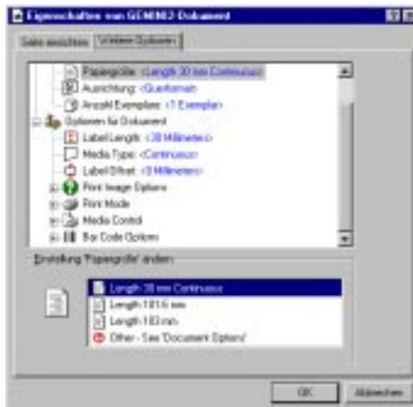
**Bild 9 h** Einstellung der Druckparameter - Optionen für Dokument unter Windows NT 4.0 (Überblick)
