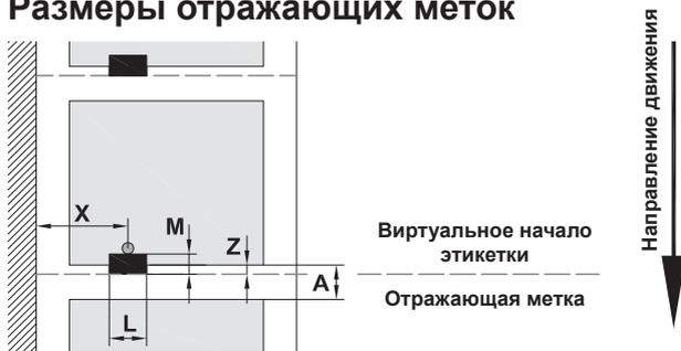
Рис. 19 Размеры отражающих меток
