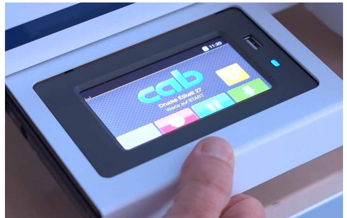
Externes cab Bedienfeld mit Touchscreen, am Gehäuse des X-TubeProcessor integriert
