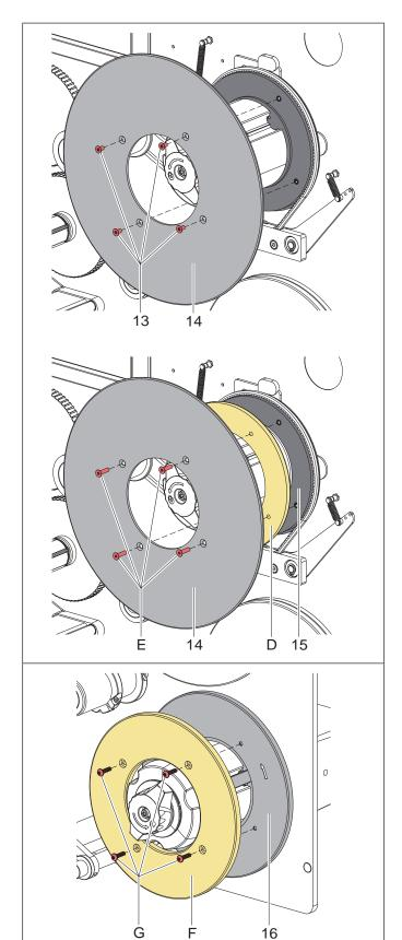
Distanzscheibe am Etikettenabwickler montieren
