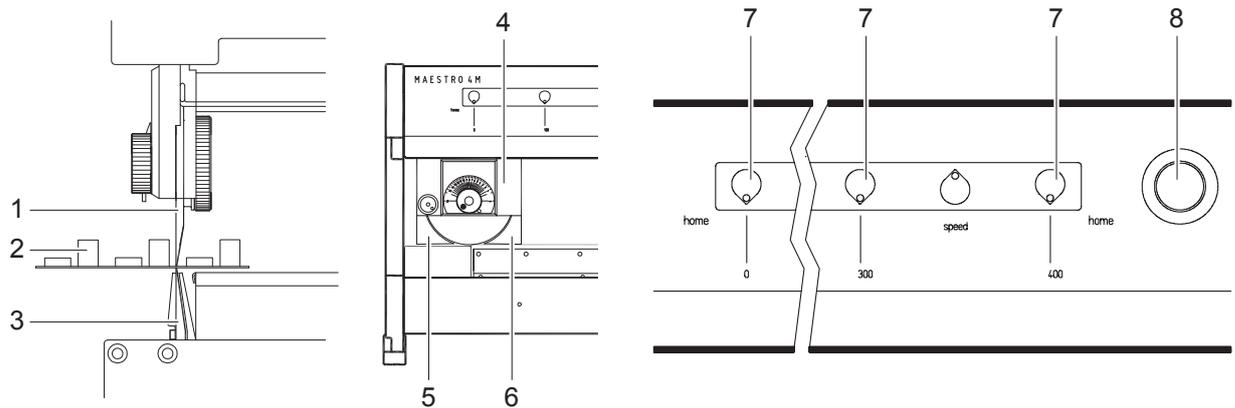
Bild 15 Trennen der Leiterplatten
