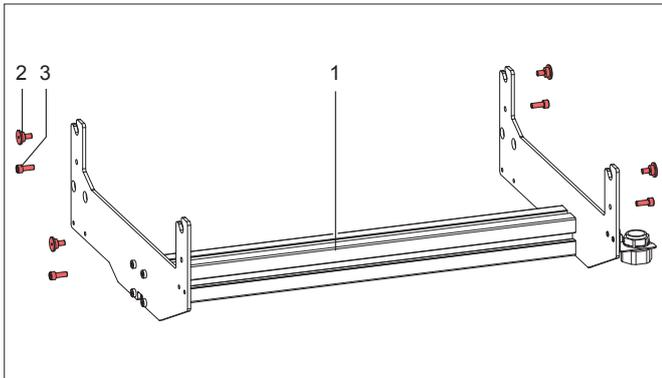
Der Bügel ist ein Montageelement, um Hermes+-Drucker hängend in eine Produktionslinie zu integrieren.
