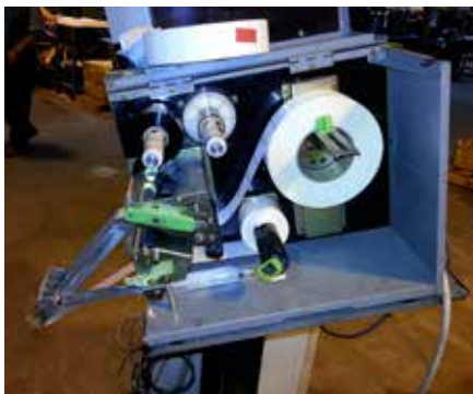
Applikator erfordert eine Drucker-Modifizierung
