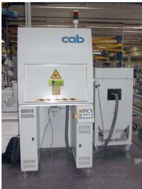
Ytterbium-Faserlaser mit Absauganlage
