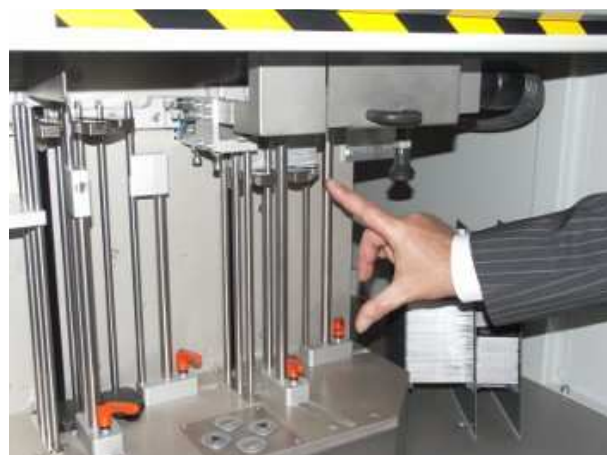
Typenschildhandlingsmodul funktioniert nach dem FIFO-Prinzip
