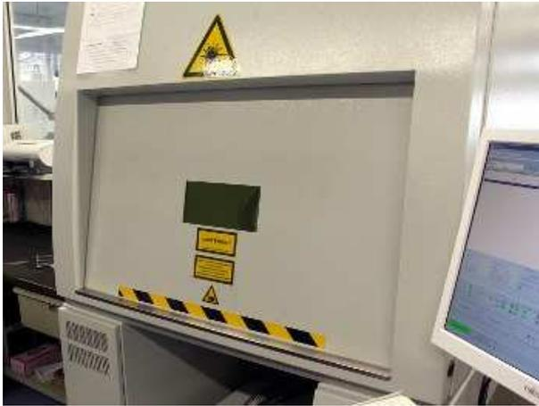
Das Laser-Werkzeug-Codiersystem kennzeichnet in wenigen Sekunden Werkzeuge aus Stahl oder Hartmetall mit einem Data Matrix Code.
