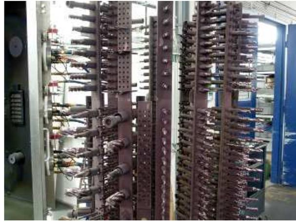
Der Beschichtungsprozess dauert in der Regel zwischen vier und sechs Stunden. Danach erfolgen verschiedene Prüfvorgänge und das Zurücksortieren
