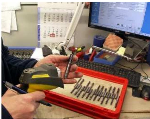
Das Laser-Werkzeug-Codiersystem ermöglicht, dass Werkzeuge nach der Beschichtung schnell und fehlerfrei ihrer jeweiligen Kommissionsnummer zugeführt werden.
