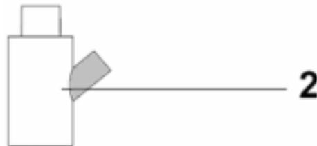
2. 在上裁刀之裁刀带动装置上，连接 Y 型管的旁边突出接口（上图灰色部分）到吸附夹（23）上，在支撑架（24）上装上吸附管（3）
