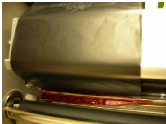
错误的安装 → 碳带盖住感应器：
