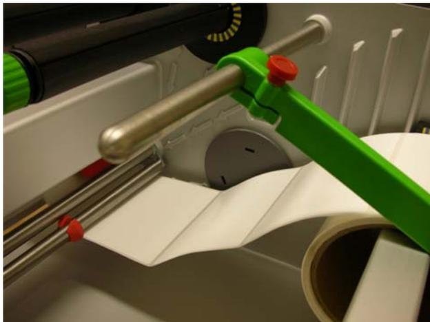
错误的安装 → 卷标纸未从卷标纸导引杆下方进入打印模块：
