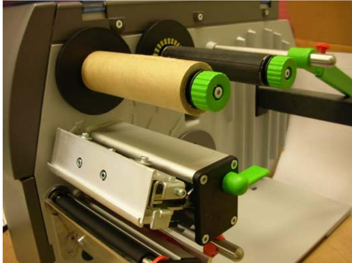
2. 于碳带供应轴一端安装新的碳带，从打印模块下方绕过印字头，切勿盖到标签纸感应器；
