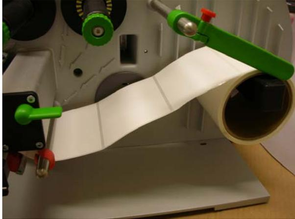
2. a3 的标签纸导引杆为单杆式设计，而 a4、a6、a8 则为双杆式设计，故安装时会有所不同，a3 的安装请参考上图，a4、a6、a8 安装如下图：
