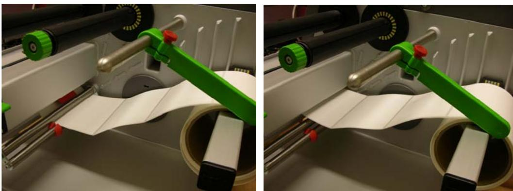
3. 将标签纸导引杆上的红色固定环推到适合卷标纸宽度的位置；
