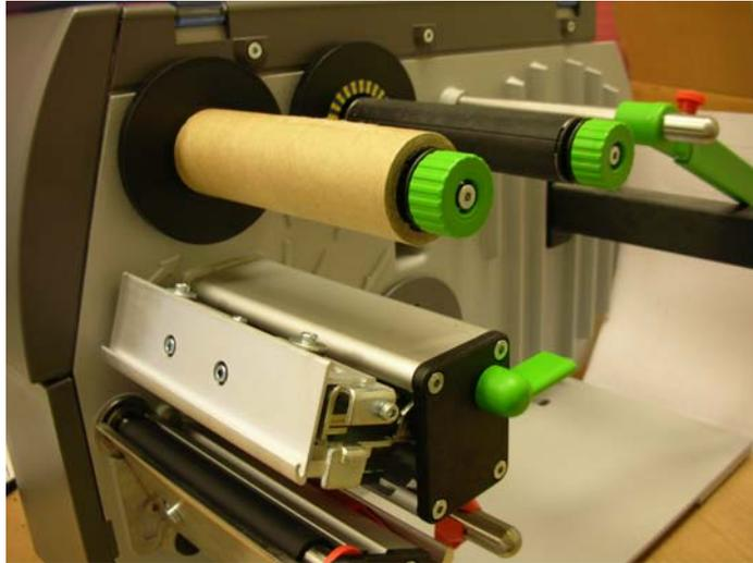
2. 於碳帶供應軸一端安裝新的碳帶，從列印模組下方繞過印字頭，切勿蓋到標籤紙感應器；
