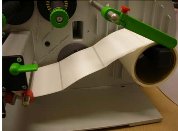
2. a3 的標籤紙導引桿為單桿式設計，而 a4、a6、a8 則為雙桿式設計，故安裝時會有所不同，a3 的安裝請參考上圖，a4、a6、a8 安裝如下圖：
