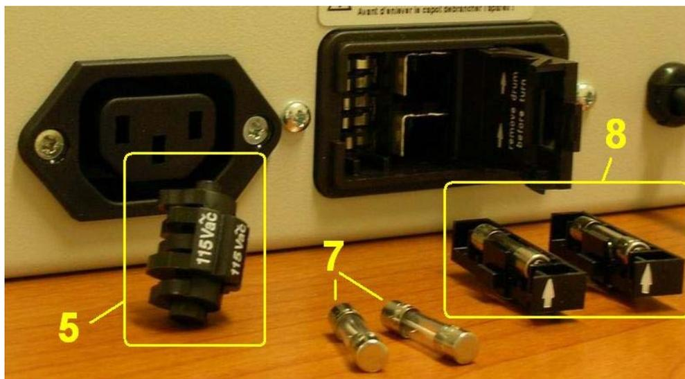
3. 選擇正確電壓值，裝回電壓設定模組及保險絲模組，並蓋上電源蓋
