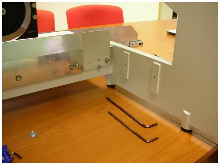
以輸送帶箱內所附的螺絲（4），固定支撐架（2）於後端桌台的螺紋孔上；
