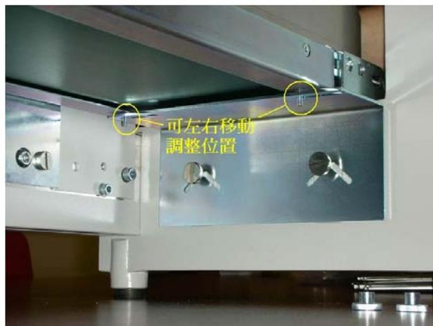
輸送帶的控制面板位置必須在 MAESTRO 4M 的右方外面，於支撐架（2）上鎖緊固定輸送帶的螺帽（3）；
