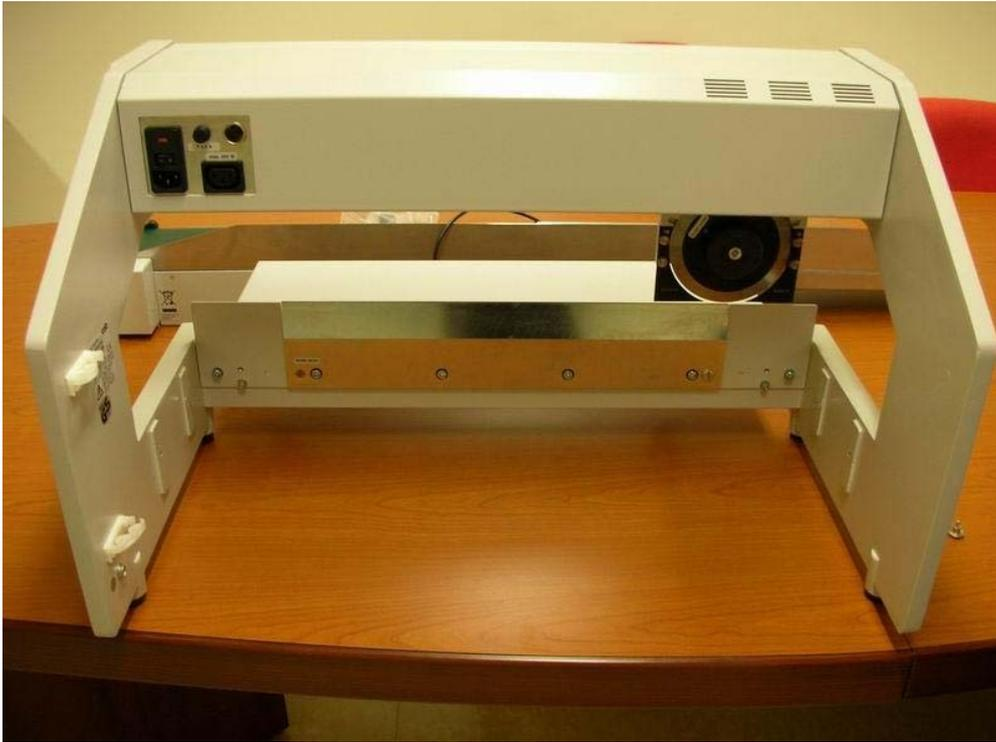
置換左邊（從前方看機器的方向）之下裁刀導引板為輸送帶所附之較短的刀片導引板（5），安裝新導引板時小心左上邊的弧角；
