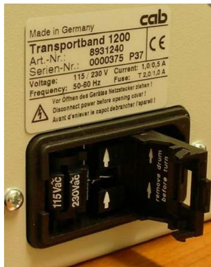
2. 取出電壓設定模組（5）及保險絲模組（8），換上正確保險絲（7）
