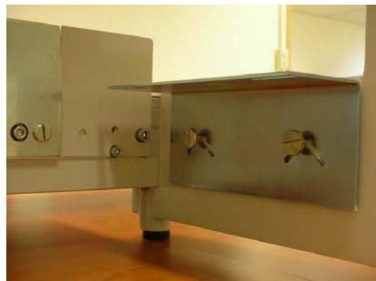
放入輸送帶，確定輸送帶的較低一端之固定螺絲（11）有卡入支撐架（2）上端的孔內；
