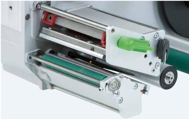
**Todos los cabezales de impresión de la misma anchura se pueden intercambiar. La CPU los detecta y calibra automáticamente. La distancia de impresión al borde de colocación es ajustable.** Los datos importantes, como el rendimiento, la máxima temperatura de servicio y la energía para calentamiento se guardan directamente en el cabezal. Los valores pueden leerse en fábrica.
