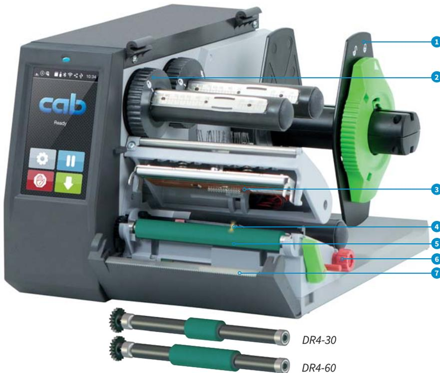
Des rouleaux d'impression étroits sont requis pour une impression précise avec les matières et rubans de faible laize. Cela permet d'éviter l'usure du rouleau, l'encrassement de la tête d'impression et les erreurs lors du transport de la matière.
