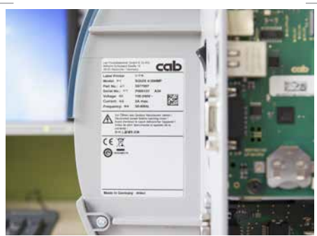
Identificación de placas de características
