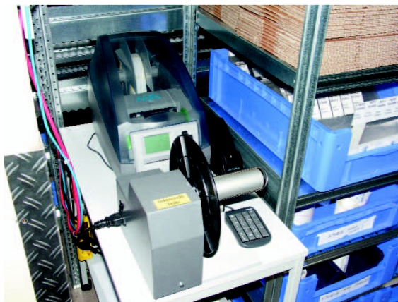
Transferdrucker mit Schneideinrichtung und externem Aufwickler
