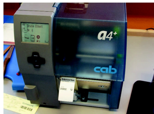
Transferdrucker an einer der vier Packarbeitsplätze
