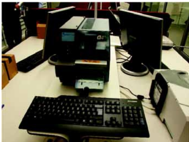
Der Thermotransferdrucker kommt bei der Auslieferung zum Einsatz. Die Eingabe des Kennzeichens erfolgt über die Tastatur.
