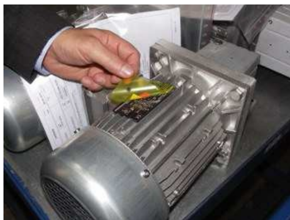
Das Typenschild wird zum Schutz während des Montagevorgangs abgeklebt.
