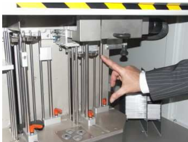
Typenschildhandlingsmodul funktioniert nach dem FIFO-Prinzip
