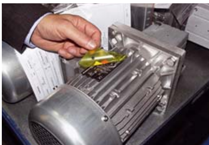
Das Typenschild wird zum Schutz während des Montagevorgangs abgeklebt
