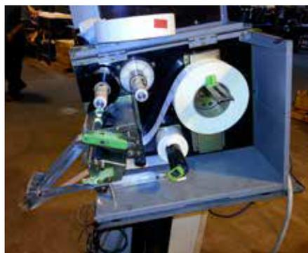
为连接滚贴模块必须对条码打印机进行改机
