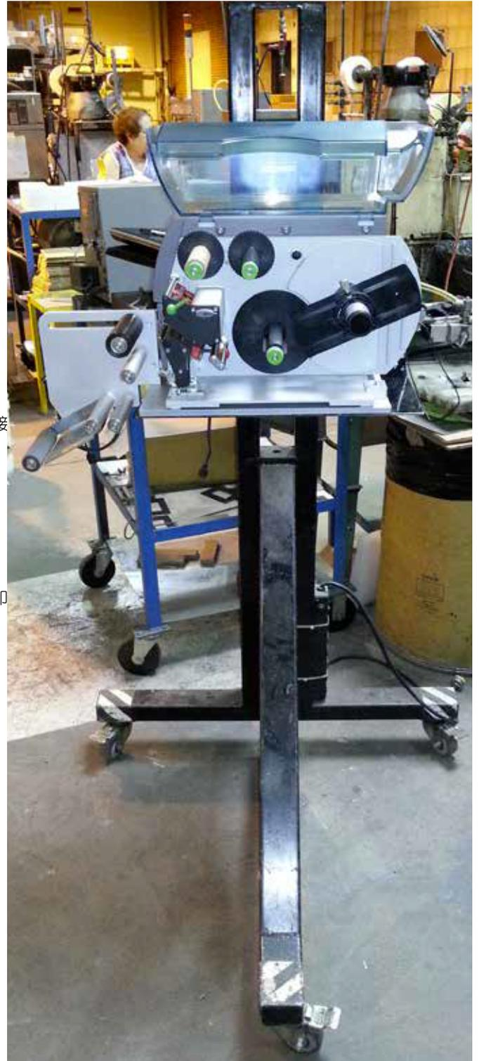
直觉、经济地安装使用 cab A4+ 条码打印机 搭配 A5104 滚贴模块
