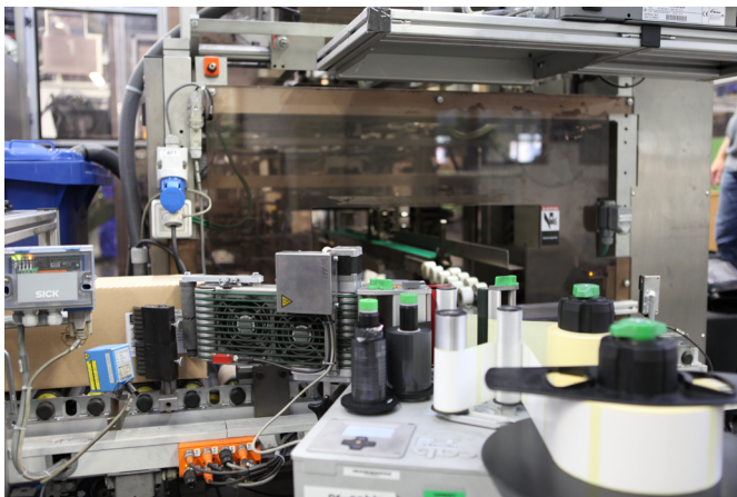
将 Hermes+ 贴标系统整合于包装线
