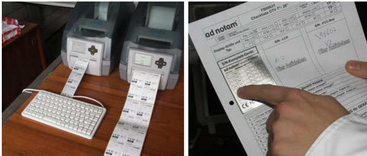
Über den Master-Drucker links wird der Etikettendruck für weitere interne Bearbeitungsschritte auf dem Slave-Drucker angestoßen.
