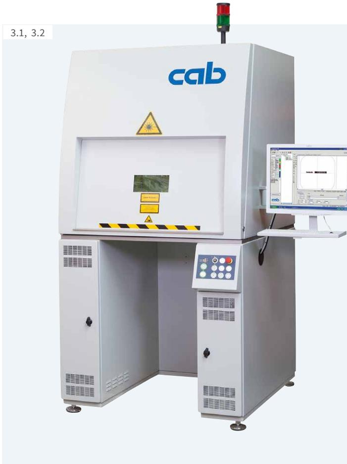
La carcasa de protección del láser LSG+ 100E es la solución industrial para el marcado de piezas de serie usando el marcador láser FL+. Su robusta estructura de chapa de acero ofrece, además de un amplio espacio de trabajo, espacio suficiente para el montaje de la fuente del haz de láser y un PC industrial dentro de un bastidor de montaje de 19".
