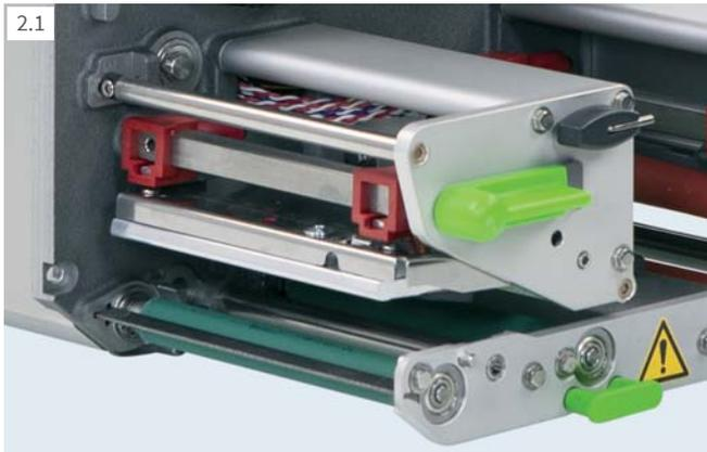
**Toutes les têtes d'impression avec la même largeur sont interchangeables. Elles sont automatiquement reconnues et étalonnées par le CPU. La distance d'impression par rapport au bord avant est réglable.**
