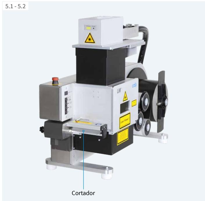
El marcador de etiquetas mediante láser permite marcar de forma precisa etiquetas de diferentes tamaños directamente desde el carrete y cortarlas sin necesidad de herramientas adicionales. Tras el marcado, las etiquetas de ribbon apto para el marcado láser pueden separarse con un cortador o rebobinarse a través de un rebobinador externo.
