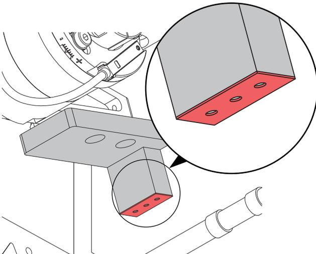
Figure 5 Nettoyage de la semelle
