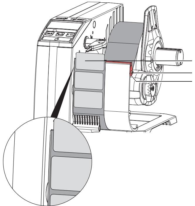
Das Etikettenmaterial läuft im Idealfall **parallel** zur Gehäusewand.
