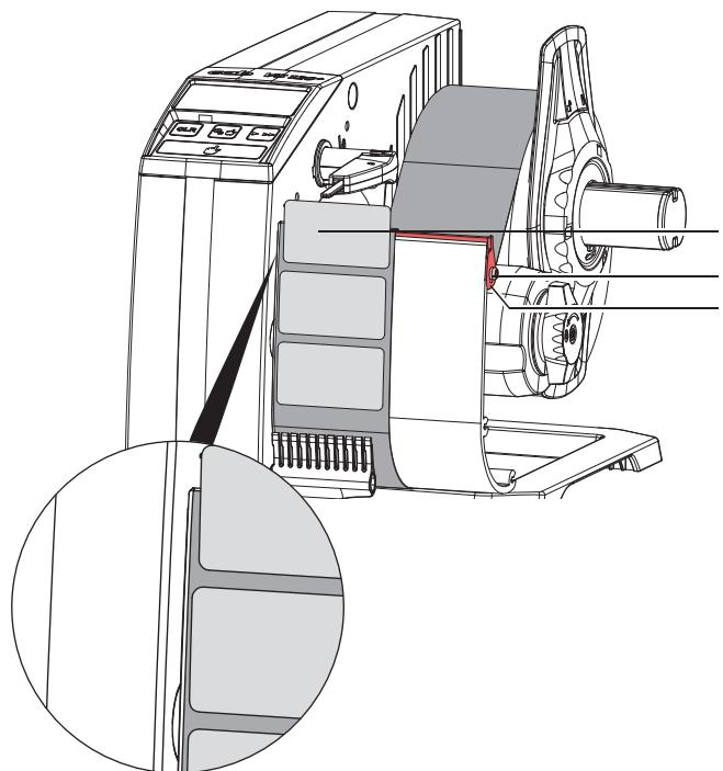
Le défilement idéal de la matière se fait **parallèlement** au châssis.
