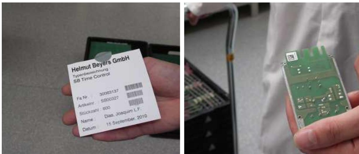
Produktetikett bzw. Typenschild für die Produktion.
