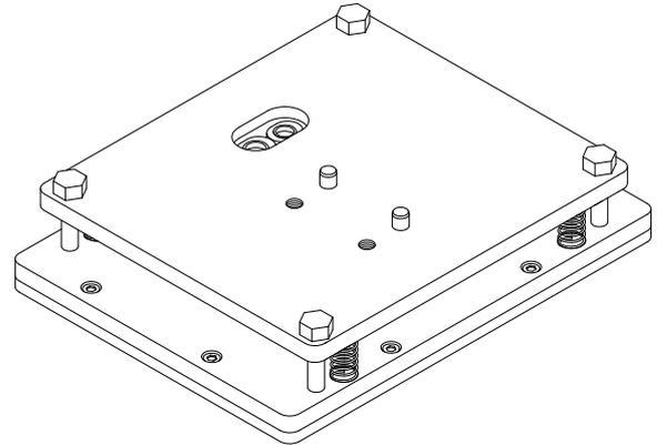
Figure 5 Semelle de tamponnage universelle sur ressorts 116x152
