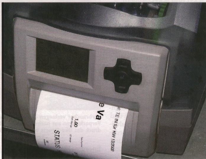
Der Barcode auf dem Beauftragungspapier wird abgescannt und die Teilekennzeichnung sofort gedruckt
