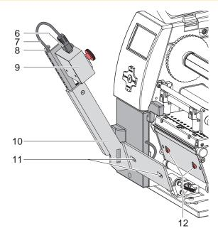
Bild 1 Barcodeprüfgerät montieren
