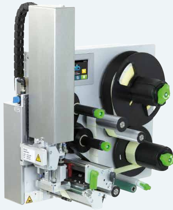
HERMES Q für automatisches Drucken und Etikettieren in Fertigungslinien
